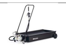
Низкопрофильная подкатная ванна объемом 95 л (номер детали 436 000), оборудованная мембранным насосом, шлангом 1,5 м и раздаточным пистолетом. Установка позволяет опорожнять контур охлаждающей жидкости транспортного средства без использования смотровой ямы или подъемника. Благодаря наличию насоса, охлаждающую жидкость можно залить обратно после ремонта контура.
